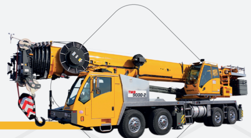
Grúa montada sobre camión
